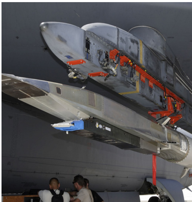
شکل ۱۳- موشک بویینگ ایکس-۵۱ که به بال هواپیمای بی-۵۲ متصل شده است.
