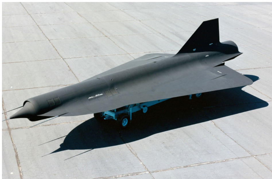
شکل ۸- هواپیمای بدون سرنشین لاکهید دی-۲۱ با پیشرانش رمجت و سرعت ۴ هزار کیلومتر بر ساعت.
